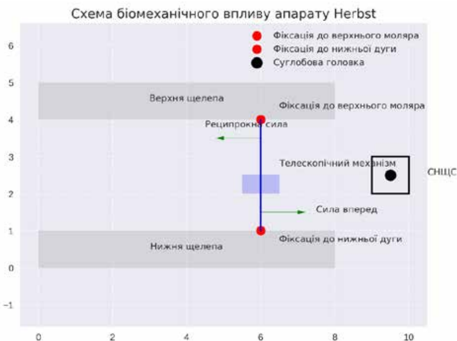
Рис. 1. Схема біомеханічного впливу апарату Herbst
