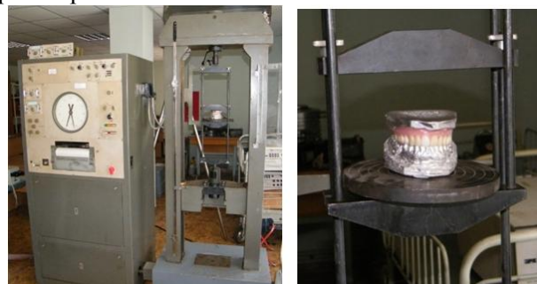
Рис. 5. Машина FU-10 000 eZ (а) с установленным в нее испытуемым образцом (б).
