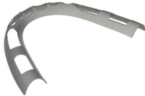
Рис. 1. Компьютерная 3-D модель универсального армирующего элемента для базиса ПСПП.
